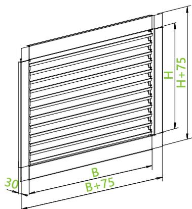
Решетки изготавливаются из унифицированных элементов, выполненных из оцинкованной стали (C-RKO) или алюминиевого профиля (C-RKA).
